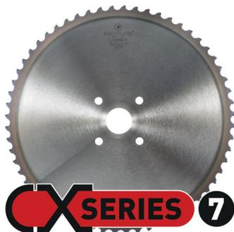
La lame CX 7 à plaquette cermet revêtue, est destinée à la découpe de barres pleines en acier carbone inférieur à 0.6% ayant une résistance pouvant aller jusqu'à 750 N/mm<sup>2</sup>. Les performances optimales de la lame sont obtenues lors de la coupe de matériaux à plus faible résistance à la traction. Pour la plupart des applications, on peut atteindre une durée de vie de lame de 50 m<sup>2</sup> et plus.
