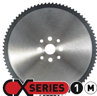
La lame de scie carbure jetable CX 1-M possède un revêtement spécialement développée pour la coupe de barre en acier carbone (teneur en carbone <0,60%) d'une résistance comprise entre 500 et 900 N / mm<sup>2</sup>.
