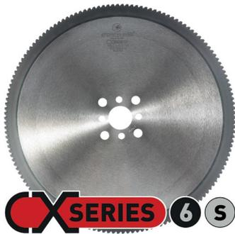
La lame scie CX 6-S à pastille carbure revêtue est recommandée pour la découpe de barre pleine en acier inoxydable de diamètre inférieur ou égal à 35 mm. Elle est capable de produire à de hautes cadences tout en assurant une bonne qualité de finition de surface.
