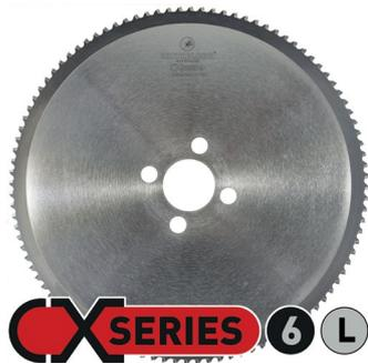
La lame de scie CX 6-L a été spécialement conçue pour la découpe de barres en acier inoxydable austénitique d'un diamètre supérieur à 35 mm à des cadences de production très élevées. Avec sa géométrie dédiée, une coupe très rapide et une bonne finition de surface peuvent être obtenues.
